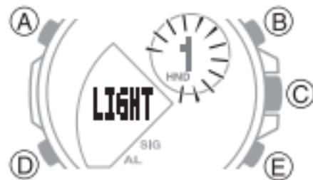
4. С помощью кнопки E установите нужную продолжительность подсветки – 1,5 секунды (на экране отобразится индикатор 1) или 3 секунды (на экране отобразится индикатор 3).
