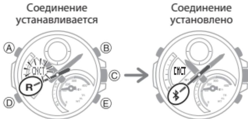
соединение между часами и смартфоном будет установлено, сообщение CNCT перестанет мигать, секундная стрелка укажет на индикатор ✘.
