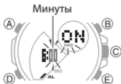
На экране отобразится мигающий индикатор типа будильника:
