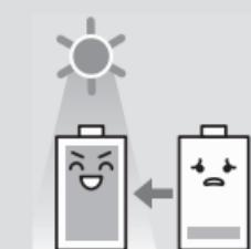
**Данные часы снабжены батарейкой, которая получает энергию от воздействия света**
