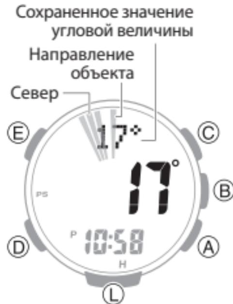
северу. Двухнаправленная калибровка перед определения направления в местах, где действуют магнитные силы. Ее нужно выполнять, если часы по какой-либо причине намагнитились и их показания отличаются от показаний, полученных с помощью другого компаса.
