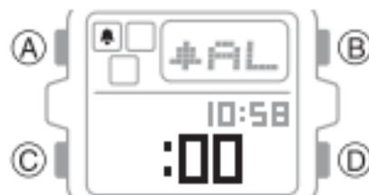
3. Нажмите кнопку **A** для включения или выключения сигнала выбранного будильника или сигнала начала часа.
